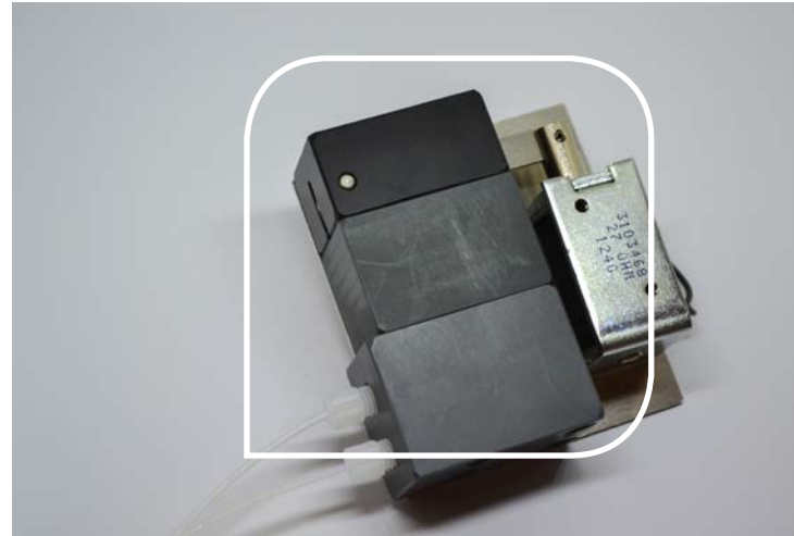
Das Pumpmodul des Wasseranalysegerätes wurde digitalisiert.
